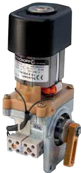
Привод с легкостью крепится на 3 болта. После включения выключателя привод автоматически взводит пружину для следующей операции включения / отключения (другая последовательность взвода предоставляется по запросу).
