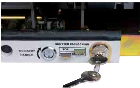
Используется только для выкатных автоматических выключателей. Это устройство блокировки блокирует автоматический выключатель в положении отсоединен посредством замков Ronis или Profalux. Когда ключ удален, защитные шторки автоматически блокируются в положении, которое предотвращает доступ к главным контактам, блокирует перемещение выключателя в кассете. Описание замка и ключа см. на странице A30.
