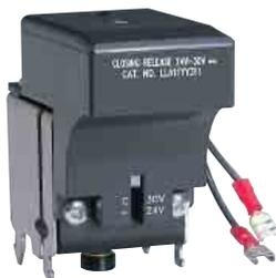
Включающая катушка позволяет непосредственно или с помощью удаленного реле управлять пружинным механизмом включения автоматического выключателя. Кроме того, существует возможность предотвращения повторного включения. Т.к. катушка работает с широким диапазоном напряжения, можно значительно снизить их число.
