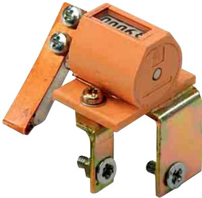
Легкоустанавливаемый на два болта счетчик, который может применяться как вместе с моторным приводом взвода пружины так и без него. Он хорошо виден на передней панели выключателя. Счетчик ведет подсчет общего числа операций включения выключателя.
