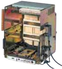
Кассета с плоскими медными клеммами, заднее присоединение, с ручкой перемещения, защитными шторками и устройствами блокировки.
