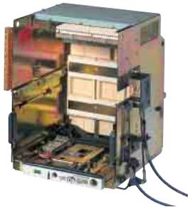
Кассета с плоскими медными клеммами (800-3200А), заднее присоединение, с ручкой перемещения, защитными шторками и устройствами блокировки. Кассеты на 4000 А имеют стандартно вертикальные клеммы заднего присоединения (не съемные).
