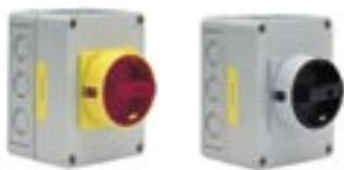
Описываемый выключатель представляет собой главный выключатель в закрытом исполнении, оснащенный рукояткой, запираемой на 3 навесных замка. Если выключатель имеет красную рукоятку и желтую переднюю накладку, то он должен использоваться в качестве аварийного выключателя, в противном случае используется сочетание черного и серого цветов.
